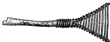
Рис. 49. Деревянная рогулька с обмоткой веревки.
